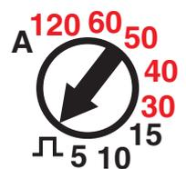
Hinweis: Wird das Relais für die Gerätesteuerung nicht genutzt, so sollte die Nachlaufzeit auf 120 min. gestellt werden, um unnötiges, regelmässiges Schalten des Kontaktes zu vermeiden.
